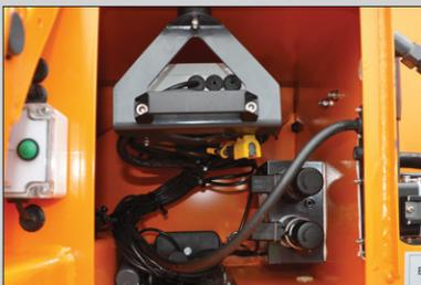
Alle wichtigen Komponenten sind in Maschinenschränken zusammengefasst, die mit einer Gummidichtleiste zusätzlich gegen das Eindringen von Feuchtigkeit und Schmutz geschützt sind.
