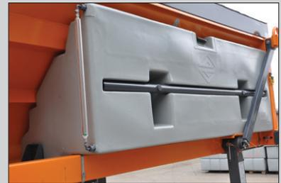
Das Verhältnis zwischen Trockenstreugut- und Solekapazität des Behälters gewährleistet eine besonders große Reichweite beim Befeuchtungsstreuen.
