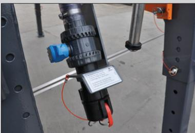
Der Bediengriff zur Solebefüllung und -entleerung sowie die Pläne befinden sich hinten am Streuer und sind vom Boden aus einfach erreichbar.
