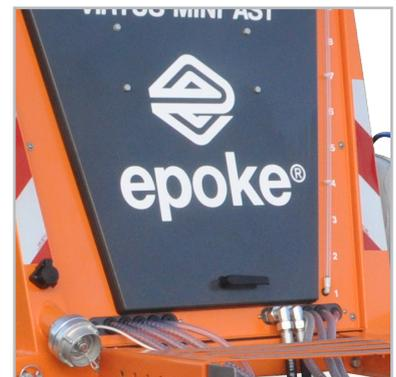
Füllstutzen und Flüssigkeitsanzeiger leicht zugänglich angebracht.
