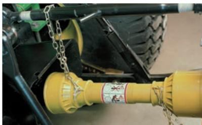
Der PM 1,4 wird von der Zapfwelle des Traktors angetrieben und ist mit 540, 800/1000 bzw. 2000 r/min der Zapfwelle erhältlich.
