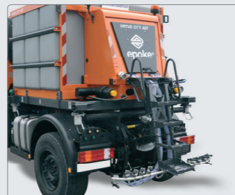
Aufstiegsleiter zum Aggregaterraum
