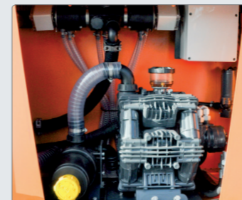
Logisch aufgebautes Flüssigkeitssystem mit Membranpumpe.
