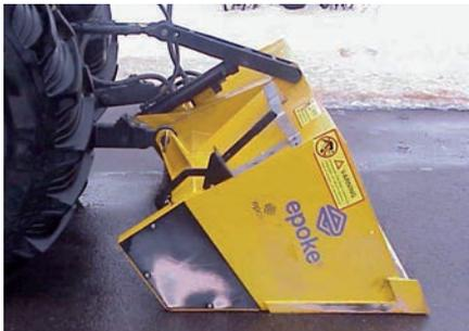
Beim Montieren des PSL-Streuers schließen die Aufzugarme in der gezeigten Position ein. Anschließend hebt ein Zylinder den Streuer in die Arbeitsposition hoch.
